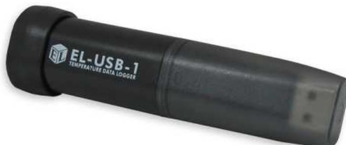
EL-USB-1 は、最大 16,382 の測定データをメモリーすることができる温度データロガーです。本体は完全防水構造 IP67 (水深 1m の場所に 30 分浸漬可能)なため、屋外での使用に対応可能です。
